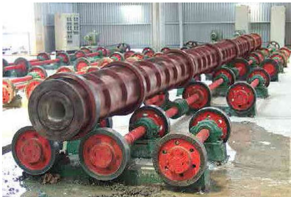
Dây chuyền sản xuất cọc ống ly tâm Spun Pile Production Line Quatity: 03 plants (BinhDuong - LongAn - QuangNgai)
